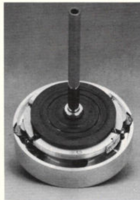
Afb. 13: Complete videokoppentrommel. Rechts en links zijn langs de omtrek de op piezokeramische dragers gemonteerde videokoppen te onderscheiden.
