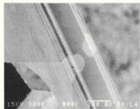
Afb. 10: Overzichtsfoto van het gebied rond de luchtspleet, schuin op de kopspiegel gezien. Duidelijk zijn te herkennen de spoorbreedte, de begrenzing van het bandloopvlak, de glasvulling van de microprofielen met de lichte gebieden en, links onder, de ruimte voor de wikkeling.
